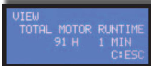
Анализ зарегистрированных оперативных данных дает информацию, полезную для оптимизации работы привода и клапана. При целевом использовании этой информации привод и клапан работают в режиме, проходяющем эксплуатационный период.
