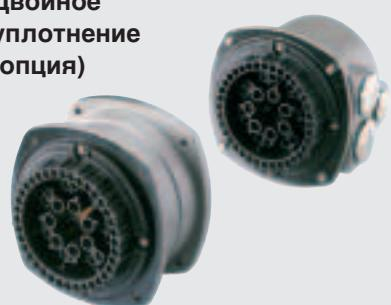
Соединение с двойным уплотнением – это герметичный штекерный разъем, который установлен между корпусом и стандартным штекерным разъемом. Даже после снятия штекерной крышки, или если кабельные вводы неправильно уплотнены, изделие будет защищено от проникновения пыли или влаги..
