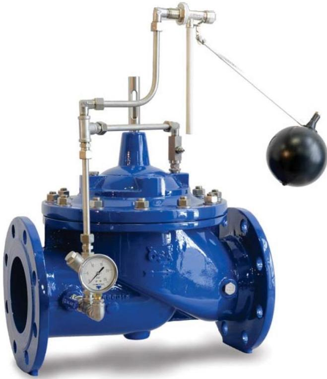
Регулирующей клапан АСТА Р02/06 автоматически поддерживает постоянный уровень жидкости в резервуаре, начиная от 15 сантиметров. Благодаря используемому в обвязке игольчатому клапану, время реагирования может быть отрегулировано, для предотвращения гидроудара в момент закрывания клапана. Важно следовать инструкции по монтажу и эксплуатации для правильной установки и минимального необходимого давления.
