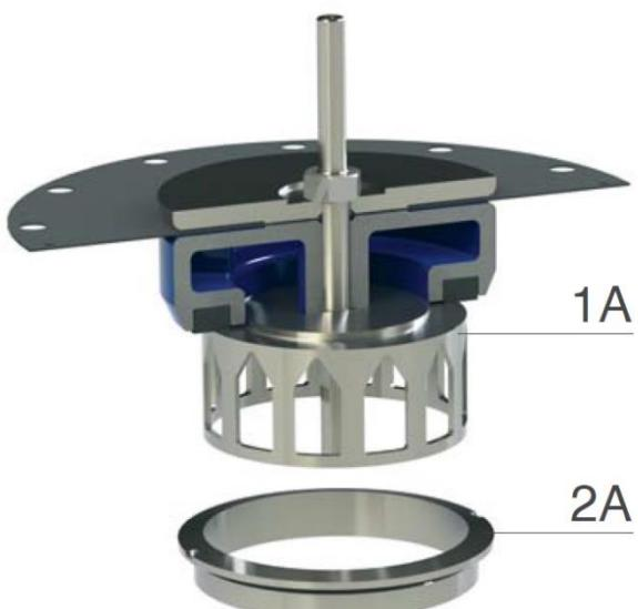
Стандартная версия подвижного блока и седлового уплотнения, описанная выше, включает плунжер, мембрану и специальный держатель прокладки, сконструированный для гарантированной максимальной точности, в том числе, при незначительно открытом клапане и, соответственно, малых расходах. Подвижный блок перемещается по направляющим, расположенным в крышке и седле.
