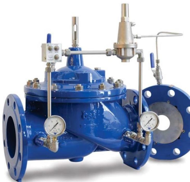
Регулирующей клапан АСТА серии Р02/09 будет автоматически ограничивать расход до заданного значения, независимо от изменения давления. При снижении расхода ниже заданного, клапан полностью открывается. Установка фланца с калиброванным отверстием (входит в комплект поставки) должна осуществляться не ближе, чем в 5 DN за клапаном.
