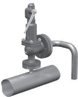
Правильная установка для воды и сж. воздуха
