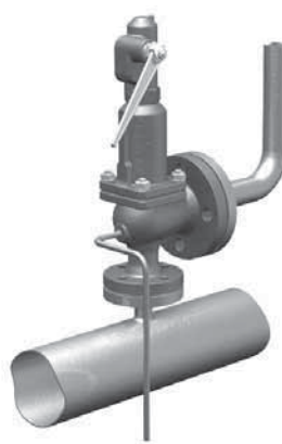
Правильная установка на паропровод
